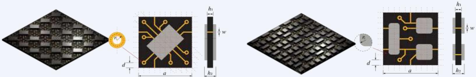
Géométrie avec courbure, en forme de filament fin, difficile à traiter avec un maillage rectiligne. Modèle de plaque avec épaisseur non-uniforme. Matériaux à 3 phases.
